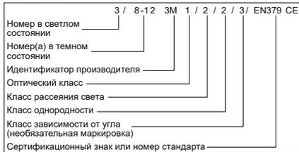
**Внимание!** Выше приведен пример. Сварочный светофильтр маркируется определенной классификацией. 3M 1BТ (EN166 удар средней энергии при экстремальных температурах (-5°С и +55°С) ВТ) 3M EN175В (удар средней энергии В) .
