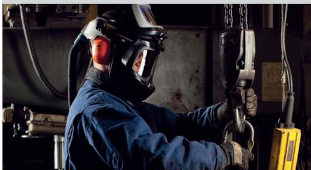
благодаря постоянно действующей защите органов дыхания класса TH3. Теперь опустите сварочный щиток и оцените возможность обзора через боковые окошки SideWindows. Вы сохраняете периферический обзор постоянно, даже в процессе сварки.
